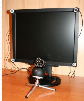
Prototyp systemu ET z ruchomą kamerą
