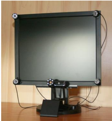
Prototyp systemu ET ze statyczną kamerą
